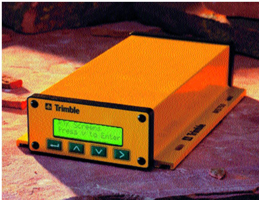
гружены непосредственно в приемник. Поэтому выводимые прямоугольные координаты согласуются с данными от GPS и от традиционных геодезических инструментов, которые могут использоваться на том же участке работ. Кроме того, через любой из трех двунаправленных последовательных портов могут выводиться сообщения в ASCII или в бинарном формате.
